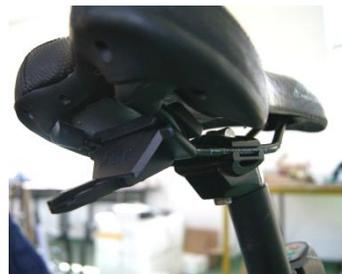
Verschrauben Sie nun die Clipplatte mit der Befestigungsplatte mittels Schrauben und Muttern.
