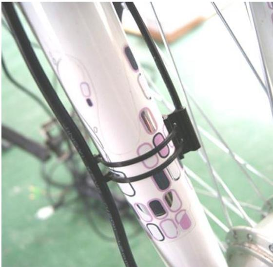
Sensor an der Gabel mittels Kabelbinder oder Gummibändern fixieren.
