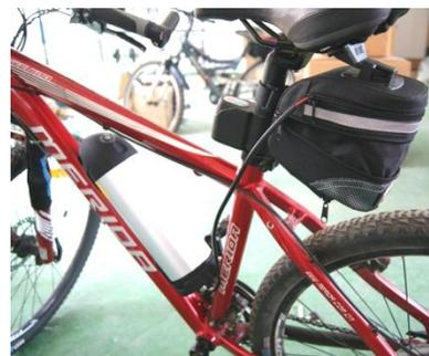
Plazieren Sie die Steuerelektronik in die Tasche und verkabeln Sie sie.
