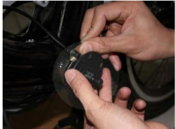
Montieren Sie nun den Magnet-Ring neben den Sensor-Ring. Sorgen Sie mittels Unterlegscheiben für ausreichenden Abstand, damit sie nicht gegeneinander schleifen.
