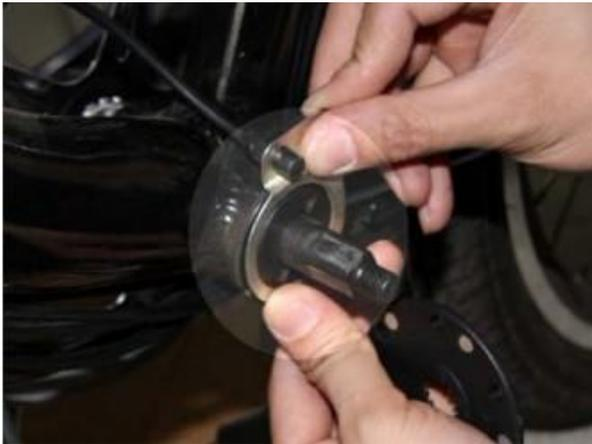
Montieren Sie den Sensor-Ring an das Tretlager und fixieren Sie ihn mittels Unterlegscheiben oder Sekundenkleber.
