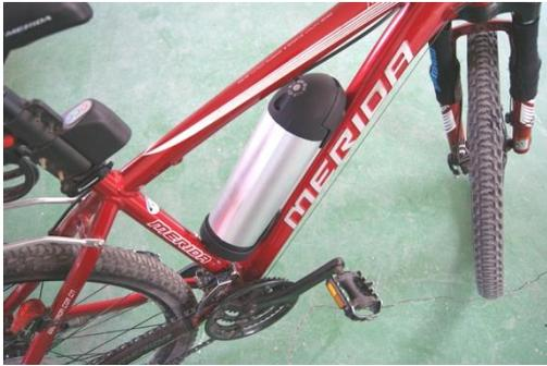
Setzen Sie die Batterie in die Halterung und verbinden Sie sie mit der Steuerelektronik.
