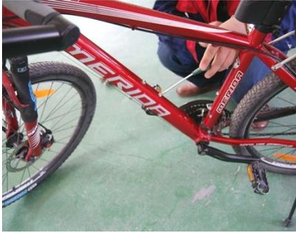
Entfernen Sie die Schrauben für die Wasserflaschenhalterung.
