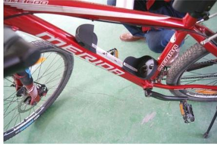
Montieren Sie nun die Batteriehalterung an den Rahmen mit den Schrauben.
