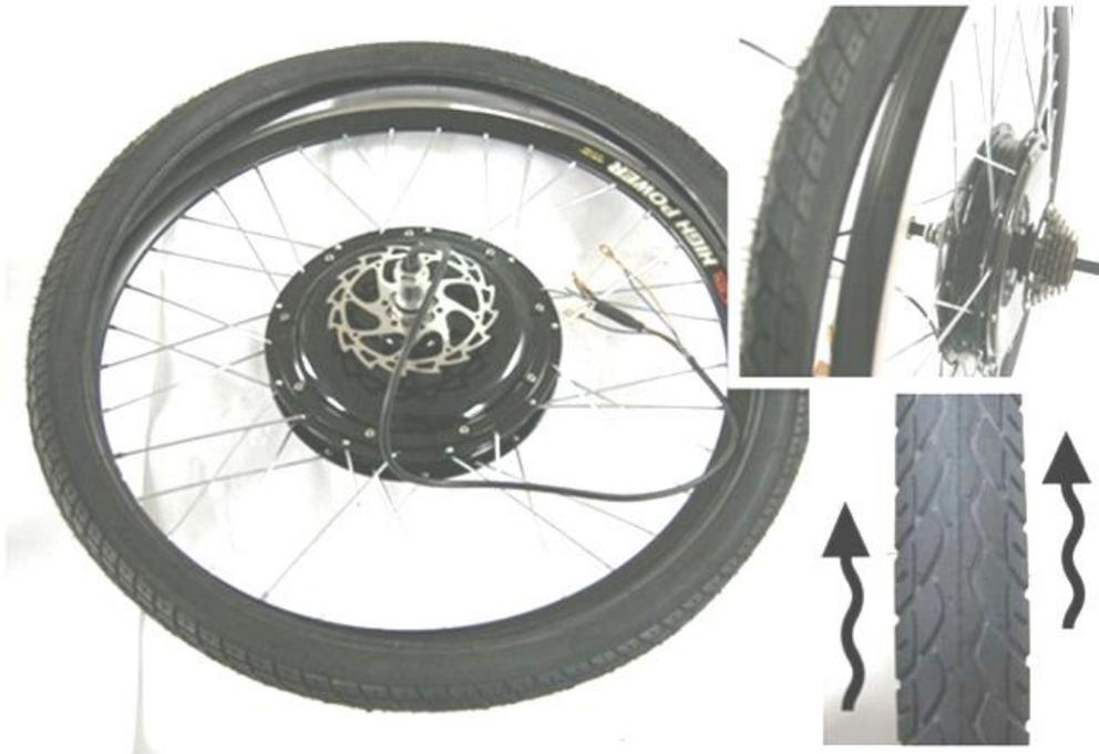
Überprüfen Sie zuerst die Laufrichtung des Profils auf dem Mantel.
