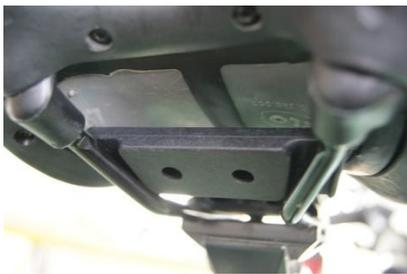
Schieben Sie die Befestigungsplatte unter die Sattelstützen.
