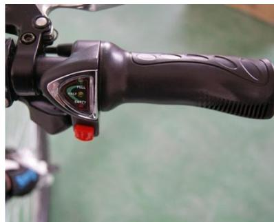
Wenn Sie mit der Positionierung zufrieden sind, sichern Sie den Gasgriff mit dem 3.0 mm Inbusschlüssel
