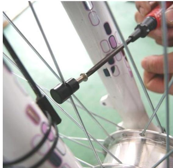
Montieren Sie den Magnet an einer Speiche mit dem Philips Schraubendreher.
