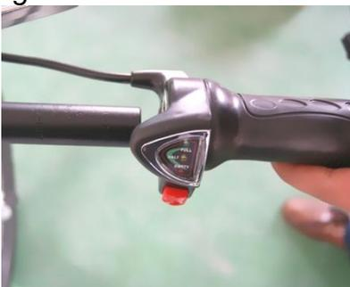
Schieben Sie den Drehgriff-Gashebel über das rechte Lenkerende und prüfen Sie die Position.
