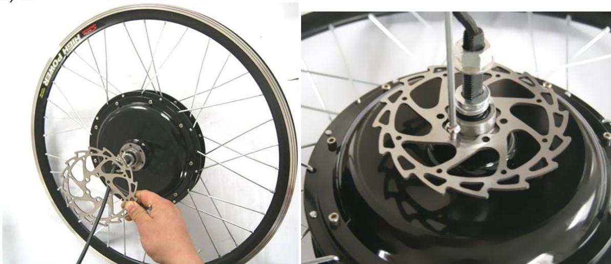
Beachten Sie den Durchmesser der Scheibenbremse. Meist werden Scheiben mit einem Durchmesser von 140 mm für das Hinterrad und 160 mm für das Vorderrad verwendet.
